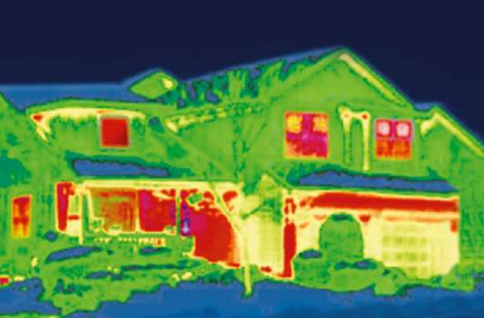
De overdracht van warmte door de ramen van binnen naar buiten is weergegeven in dit infraroodbeeld. De rode delen geven de hoogste graad van warmteverlies weer.
